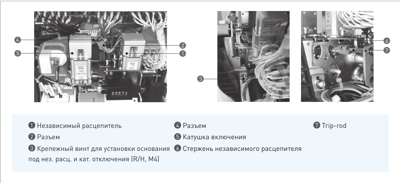
Рис.10. Установка независимого расцепителя
